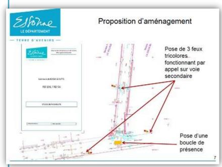
La proposition consistait à rajouter des feux tricolores pour réguler l'accès au croisement et permettre aux camions de tourner sans qu'aucun autre véhicule ne soit présent sur la quinzaine de mètres de chacune des voies de part et d'autre du croisement.
